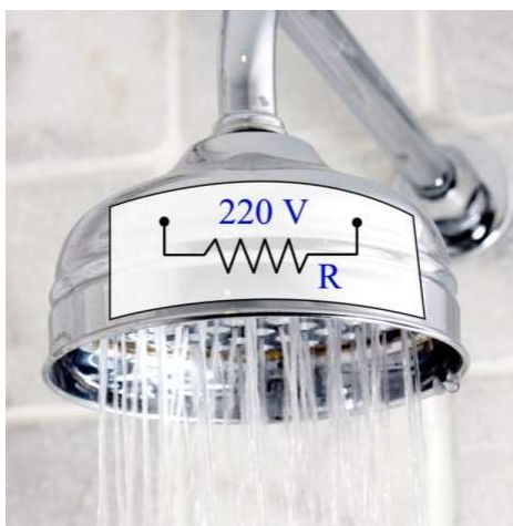
Fig. 5- Um aquecedor de água é baseado no efeito Joule.
