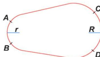
Fig. 4- A densidade elétrica varia de ponto a ponto.
