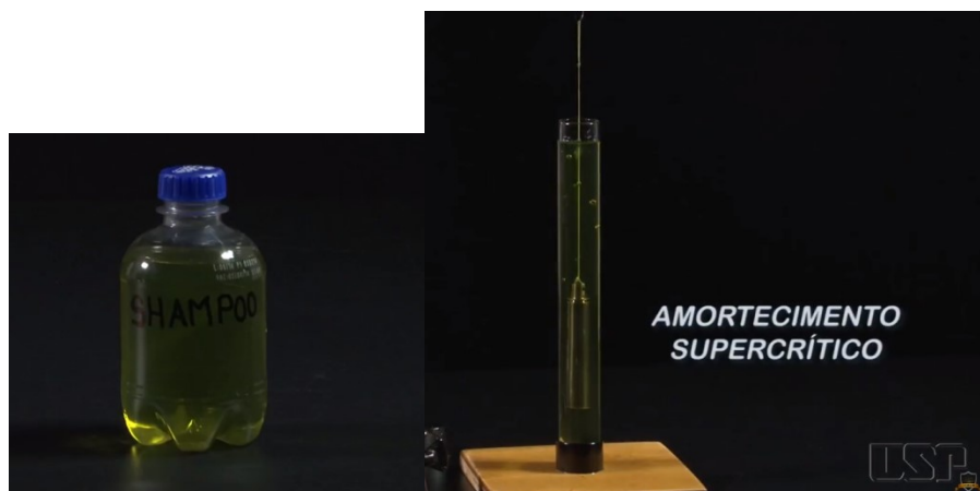
Fig. 3- Este tipo de amortecimento ocorre quando colocamos a partícula para oscilar no interior de um tubo contendo um óleo viscoso.
