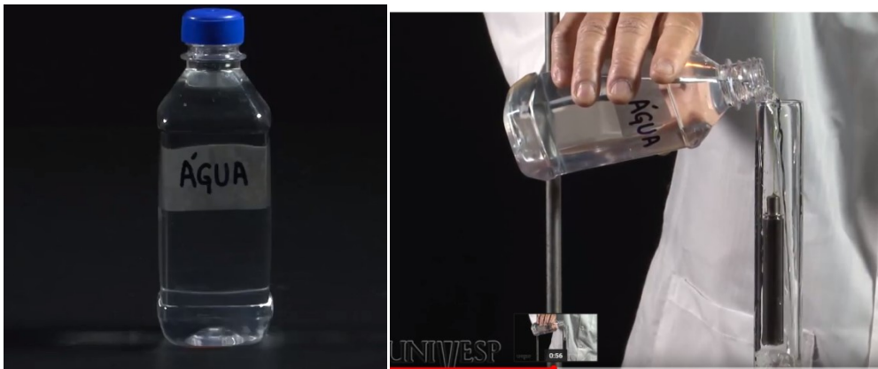
Fig. 1- Quando colocamos água, num tubo, atingiremos uma situação descrita como amortecimento subcrítico, ou subamortecidas.
