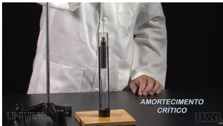
Fig. 2- Este tipo de movimento ocorre quando colocamos a partícula para oscilar no interior de um tubo contendo, por exemplo, um detergente.
