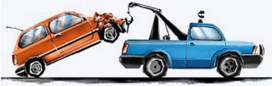
Fig. 3- No guincho dos veículos de socorro a acidentes graves existe uma roldana que ajuda a içar o carro acidentado.
