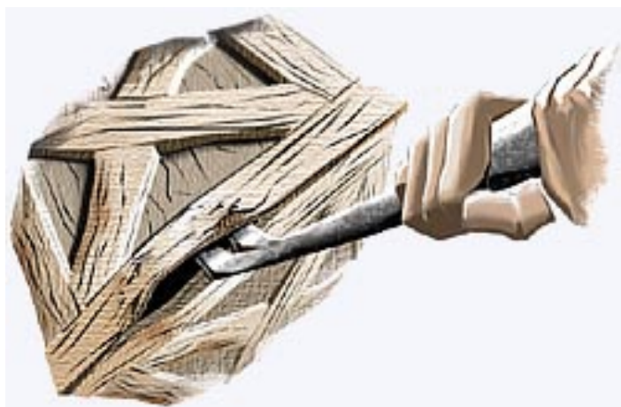
Fig. 2- Ao abrir caixotes com pregos você usa um pé-de-cabra ou um martelo que funcionam como alavancas
