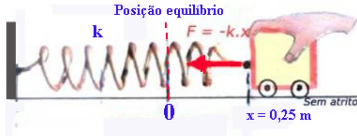
A partir da posição de equilíbrio o carrinho, é puxado para a direita até que a elongação da mola atinja o valor:  $x = 0,25$  m. Esse é o valor da amplitude  $x_M = A = 0,25$  m.. Depois de solto, o sistema se comporta como um oscilador harmônico, realizando Movimento Harmônico Simples.
