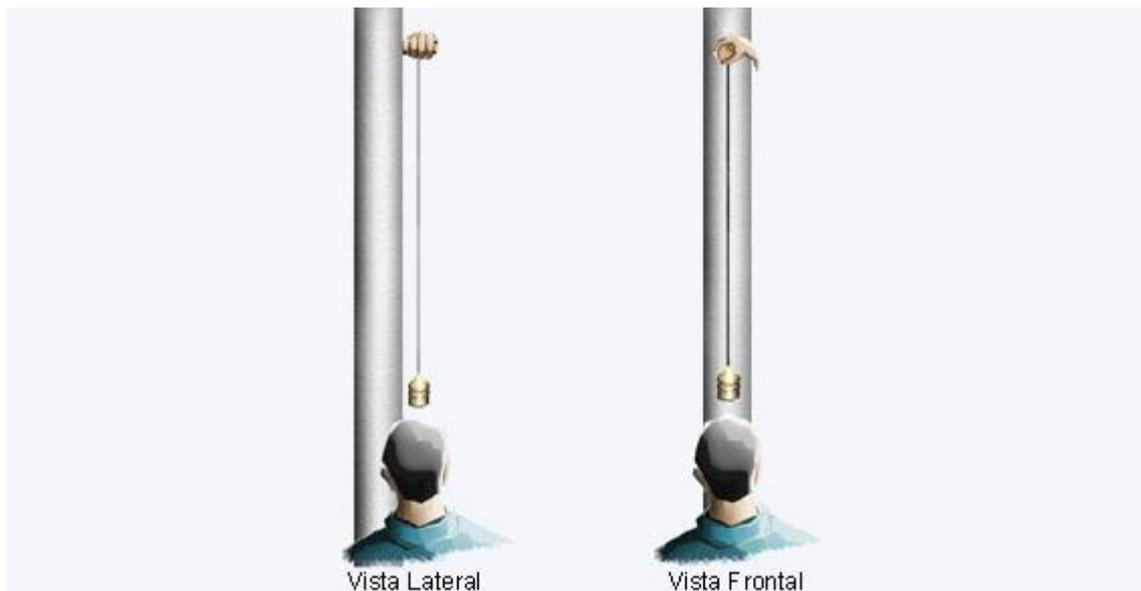
Quando o Sol estiver exatamente a pino, não é possível observar qualquer sombra do cilindro no solo. Inicie nessa situação a medição do intervalo de tempo. No dia seguinte, exatamente nas mesmas condições de sombra, termine a medição do intervalo de tempo. Deve dar aproximadamente 24h.
