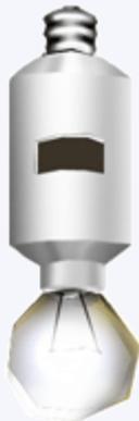
Lâmpadas que acendem automaticamente conforme a luminosidade. Nessas lâmpadas existe um mecanismo, que quando a luz bate há a emissão de elétrons. Dependendo da intensidade luminosa não há fornecimento de energia elétrica necessária para acender a lâmpada. Quando está escuro o circuito se fecha e a lâmpada....
