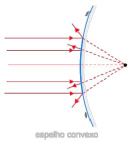
O foco de um espelho de Gauss é um ponto ao longo do eixo principal equidistante do centro de curvatura C e do vértice V.
