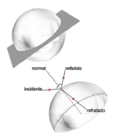
No caso em que a superfície esteja polida exibindo uma reflexão regular, uma calota esférica se constitui num espelho esférico. Uma calota polida de um carro pode ser pensada como um exemplo de um tal espelho (desde que a calota seja esférica).
