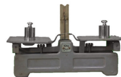
Fig. 1.6. Balança romana: baseada na comparação das forças peso.
