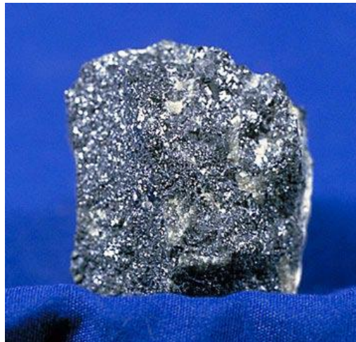
Figura 2. A magnetita, ou a pedra-ímã, um ímã natural.
