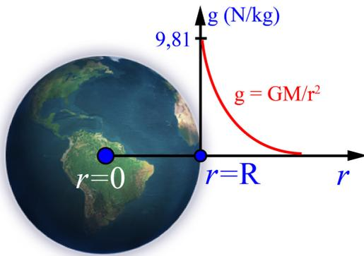
Figura 18.14 Para os pontos externos à distribuição, tudo se passa como se toda a massa estivesse concentrada no centro da distribuição esférica.
