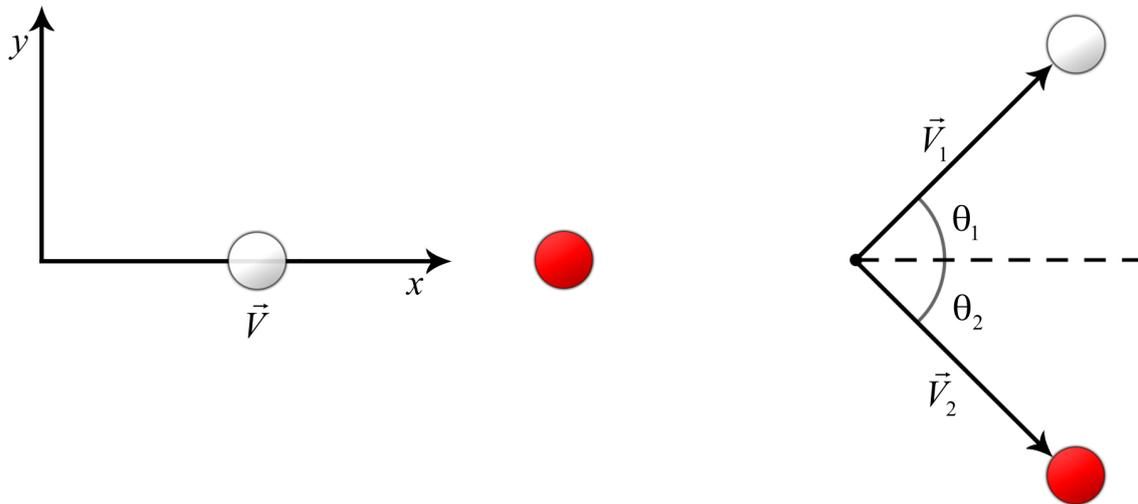
Figura 15.14 - Colisão de duas bolas de bilhar. Admitindo-se que a colisão seja elástica, temos uma equação a mais à nossa disposição.
