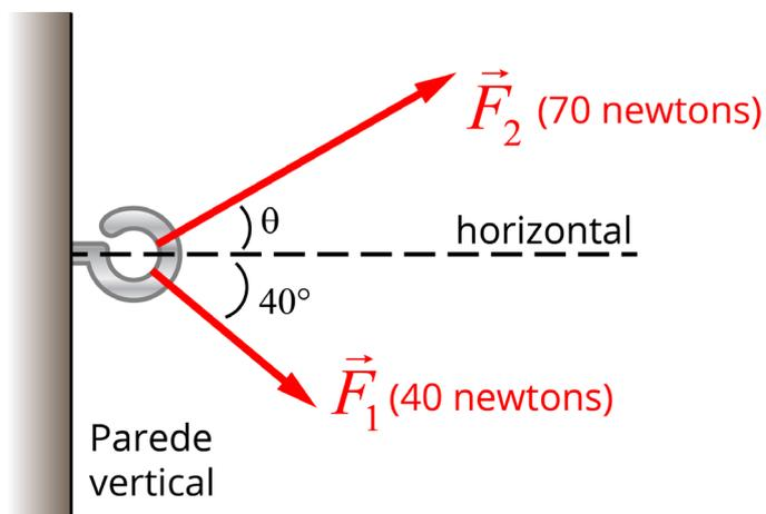
Figura 4.16: Esquema das duas forças agindo sobre o pitão.
