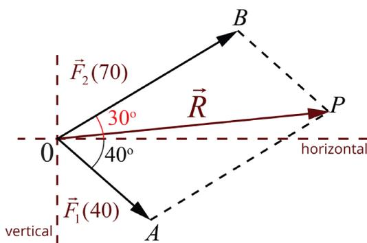
Figura 4.14: Vetor resultante de acordo com a Regra do Paralelogramo.
