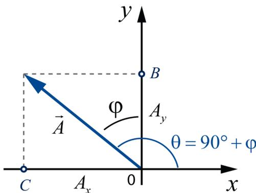
Figura 4.6: Componentes de um vetor.
