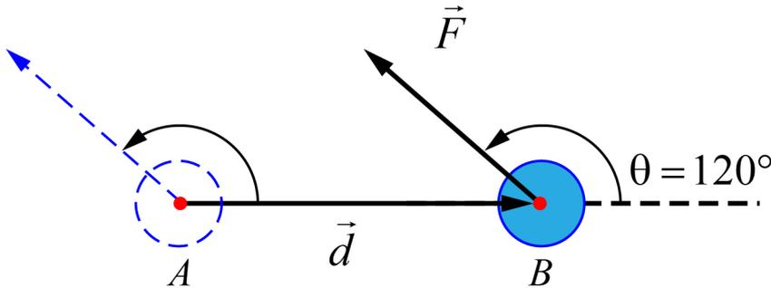
Figura 4.23: Trabalho de uma força quando a partícula se desloca do ponto A até um ponto B. O módulo do vetor deslocamento é igual à distância entre eles.
