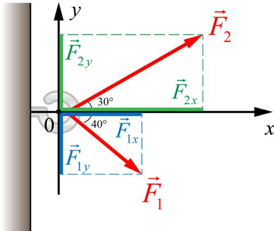
Figura 4.17: Componentes de  $\vec{F}_2$  em verde e as de  $\vec{F}_1$  em azul.
