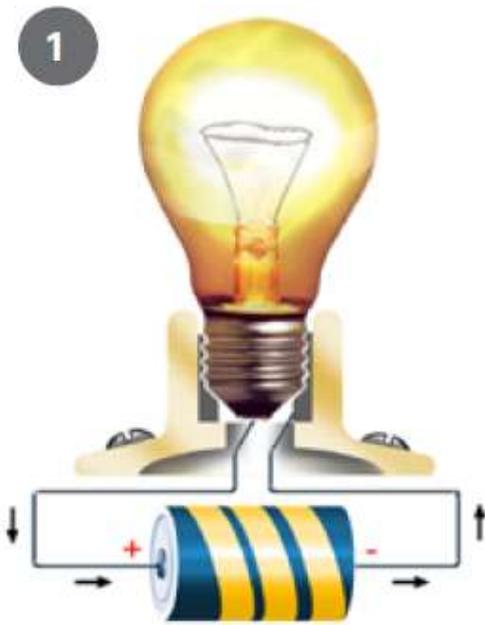
Fig. 6- Aprendemos a produzir luz fazendo passar uma corrente elétrica por um filamento mantido no interior de uma lâmpada. A corrente elétrica nada mais é, do que cargas elétricas em movimento.
