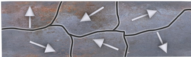
Fig. 3 - Formação de domínios num ferromagnético.
