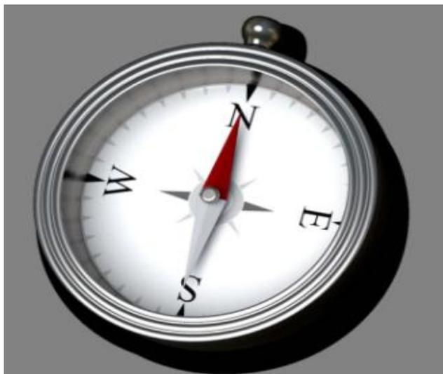
Figura 5- A bússula funciona por conta da existência do campo magnético da Terra.
