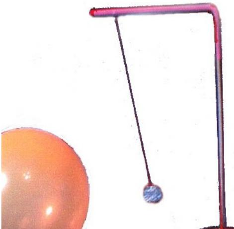
Fig. 3- Com um pêndulo elétrico podemos constatar a existência de um campo elétrico.
