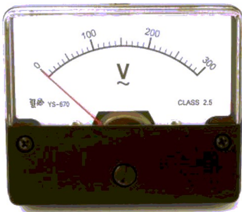
Fig. 3- Voltímetros são feitos para medir diferenças de potencial.
