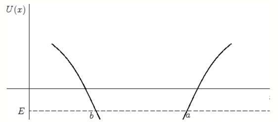
A figura acima mostra um poço de potencial e os pontos, b e a, de retorno de uma partícula de massa m e energia E.
