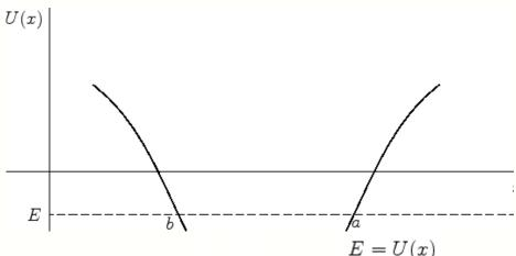
Na figura acima vemos os pontos a e b, em que , e a aproximação quase-clássica falha. Classicamente são os pontos em que a partícula para e volta, os "pontos de retorno". Nas vizinhanças desses pontos não podemos utilizar a expressão (781). Há uma série de métodos para contornar esta
