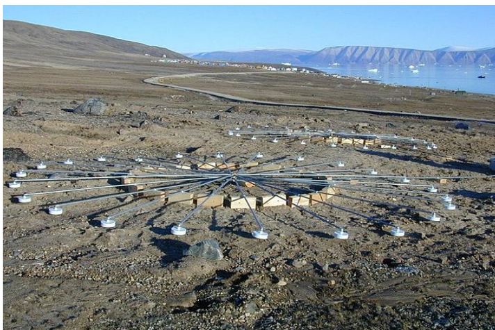
Fig. 4- Matrizes infrassônicas na estação de monitoramento de infrassom localizado na Groenlândia.
