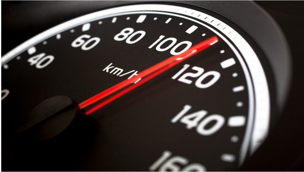
Fig. 3- O velocímetro indica a velocidade instantânea de um veículo em Km/h. Ou seja, se mantida aquela velocidade, ela indica a distância que se pode percorrer em 1 hora.
