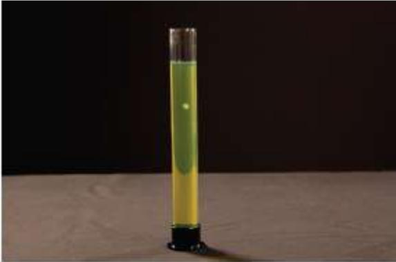
*Fig. 25.2. Uma esfera de metal em um tubo executa, ao descer, movimento uniforme.*
