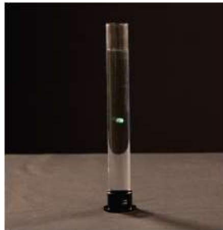
Fig. 25.5. Medindo-se a velocidade final podemos determinar o parâmetro b e com isso estimar o coeficiente de viscosidade.
