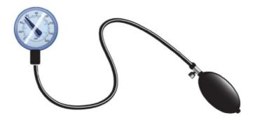
Os borracheiros utilizam outro instrumento, dito calibrador de pneus.
