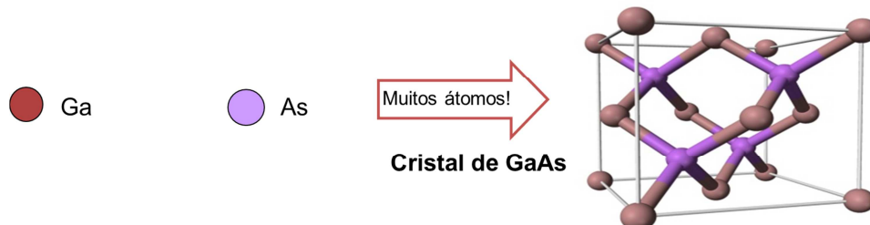
Figura 2: Estrutura cristalina do GaAs.
